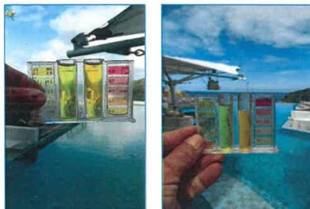
ภาพถ่ายที่ 3.4.2-1 ภาพถ่ายการตรวจวัดความเป็นกรดต่าง และค่าคลอรีนอิสระคงเหลือของสระว่ายน้ำ ในโรงแรมประจำวัน
